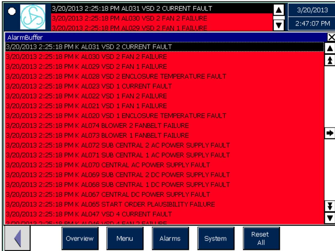
Im Menü „Alarmbuffer“ werden die letzten 256 Alarmer angezeigt. Somit besteht auch nach einem Störfall oder einem Spannungsausfall die Möglichkeit zu sehen, welche Alarmer vor der Störung anstanden, um somit die Ursache einer Störung schneller ermitteln zu können.
