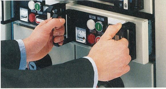
**03** Die MCC-Einschubfelder in Volleinschubtechnik können Motorstarter bis 200 kW und Energieabgänge bis 630 A handhaben
