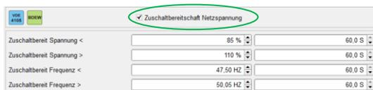
Funktion muss aktiviert werden. Soll die Funktion nicht grundsätzlich freigegeben werden, so kann sie über einen entsprechend parametrisierten Digitaleingang gesperrt werden.
