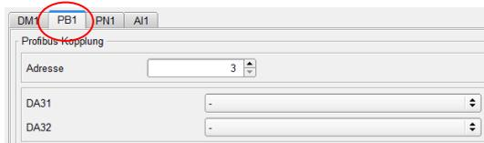
Um die Einstellungen für die Profibus - Kopplung vorzunehmen, muss das PB1-Modul unter der Registerkarte „Grundeinstellungen“ aktiviert werden. Wenn das Modul aktiviert ist, jedoch nicht auf dem Busverbinder steckt, kommt der „Watchdog“ Fehler.
