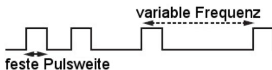
Bei Modulationsart PFM besitzt der Stellimpuls eine feste Impulslänge beziehungsweise Impulsdauer. Je nach Regeldifferenz (und eingestellter Verstärkung) variiert die Puls-Pause beziehungsweise die Frequenz. Je größer die Abweichung, desto mehr (gleich lange) Impulse pro Minute.
