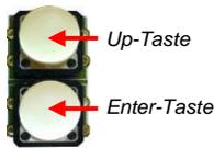
Im Modus Parametereinstellung (DIL-Schalter S2 geschlossen, Eingabeschutz mit PIN inaktiv) wird im Gerätedisplay die Auswahl der Parametergruppe (*Parametergruppen siehe Kap. Anhang 1*) angezeigt. Mithilfe der Up-Taste (*siehe Kap. 5.1.1*) kann nun die jeweils zu bearbeitende Parametergruppe angewählt werden.
