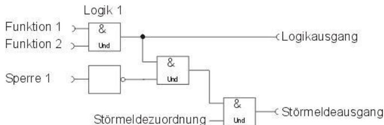
Alle Logik- und Timerfunktionen lassen sich den Störmeldeguppen und der Sammelstörung zuordnen. Die verfügbaren Sperrfunktionen sind ebenfalls für alle Logik- und Timerfunktionen verfügbar. Jede Eingangsfunktion ist invertierbar.
