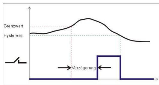
Jeder Schaltpunkt kann einem Relaisausgang (siehe Kap. 12.1 - Digitale Ausgänge) zugeordnet werden.
