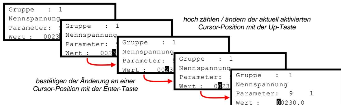
Wenn die letzte Ziffer (die linke Position) des zu ändernden Wertes editiert und mit der Enter-Taste bestätigt wurde, erfolgt eine Sicherheitsabfrage, mit der die Änderung des Parameter-Wertes zu bestätigen ist. Mittels Up-Taste kann hier die aktuelle Änderung verworfen werden. Die bisherige Einstellung bleibt erhalten. Mit Betätigen der Enter-Taste (ENT) wird die Eingabe des Parameter-Wertes übernommen und im Flashspeicher des SYR2 gespeichert. Der Wert ist unmittelbar nach Bestätigung gültig.
