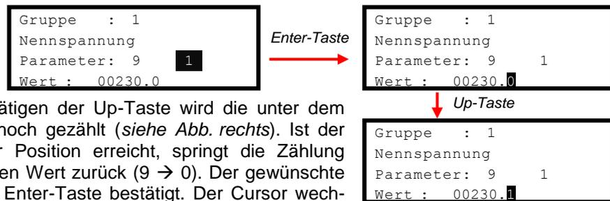
Durch wiederholtes Betätigen der Up-Taste wird die unter dem Cursor aktivierte Ziffer hoch gezählt (*siehe Abb. rechts*). Ist der höchste Wert in dieser Position erreicht, springt die Zählung wieder auf den niedrigsten Wert zurück (9 → 0). Der gewünschte Einstellwert wird mittels Enter-Taste bestätigt. Der Cursor wechselt zur nächsten Ziffer.
