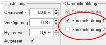
Das Gerät bietet die Möglichkeit zwei unabhängige Sammelstörungs- signale zu bilden. Diese werden aus den einzelnen Grenzwerten zusammengesetzt. Der Anwender kann so ein bestimmtes Ereignis selbst konfigurieren.
