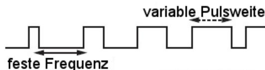
Bei Modulationsart PWM ist die Frequenz fest. In Abhängigkeit der Regelabweichung (und der eingestellten Verstärkung) ändert sich die Impulslänge bzw. Impulsdauer.
