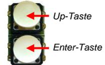
Die gespeicherten Auslösewerte werden gelöscht, indem im Störmeldebild die UP-Taste für ca. 10 Sekunden gedrückt gehalten wird (Display-Ausgabe siehe Abb. rechts). Anschließend sind alle bisher gespeicherten Auslösewerte, jedoch nicht der Zählerstand für alle Auslösungen (siehe oben), gelöscht.
