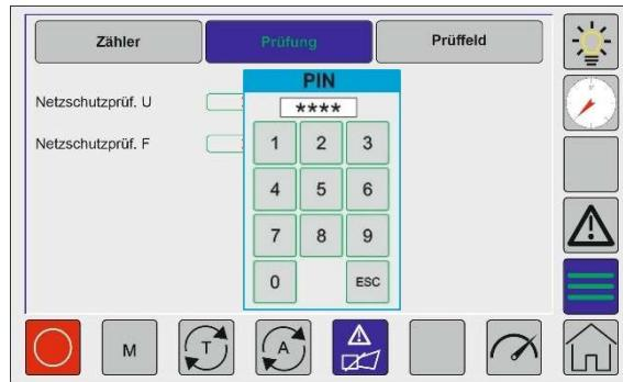
Im Untermenü „Zähler und Funktionen“ die Schaltfläche „Prüfung“ anwählen.
