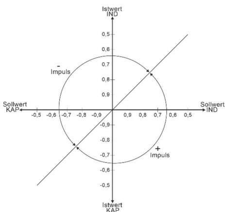
Zur Vermeidung von Übertragungsverlusten wird ein möglichst hoher Leistungsfaktor angestrebt. Mit der Cos Phi - Regelung erfüllt die Kompaktautomatik GECO20 die entsprechenden Anforderungen nach leistungsfaktorbezogener Anlagensteuerung.
