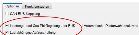
Als Erweiterung der Regelung über den BUS, gibt es die Option einer lastabhängigen Ab- und Zuschaltung von Aggregaten.
