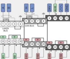
Der Analogeingang 1 ist für die Vorgabe des Leistungssollwertes. Über die Skalierung kann der Eingang individuell angepasst werden.
