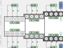
Es stehen drei Analogeingangsmodule mit jeweils 6 Analogeingängen zur Verfügung. Die Beschreibung erfolgt exemplarisch am Analogeingang 5 auf dem Modul 1.
