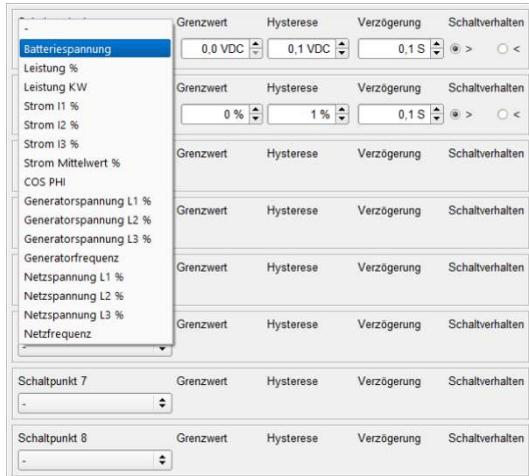
Es stehen insgesamt 16 Schaltpunkte zur Verfügung, mit denen jeweils eine ausgewählte elektrische Größe auf Unter- oder Überschreiten eines eingestellten Grenzwertes überwacht werden kann. Jeder Schaltpunkt kann einem Digitalausgang zugeordnet und/oder in Logikfunktionen verarbeitet werden.
