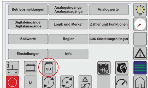
Wenn eine SD-Karte auf der Rückseite vom GTP20 gesteckt ist, wird dieser Button eingeblendet.
