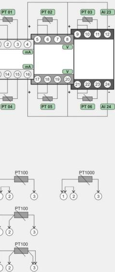
Es stehen zwei Messmodule mit jeweils 6 PT100(0) Messeingängen und 2 Analogeingänge zur Verfügung. Die Beschreibung erfolgt exemplarisch am Eingang 1 auf dem Modul 1.
