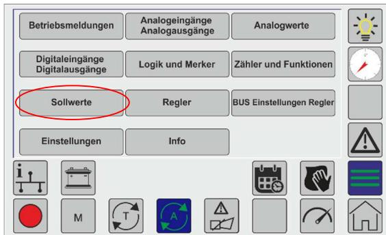
Es können für drei verschiedene Regler die Sollwerte vorgegeben werden. Für den Leistungsregler und für den CosPhi - Regler kann zusätzlich vorgewählt werden, ob auf den eingestellten Sollwert am Tableau (Intern) oder auf den Analogwert (Extern) geregelt werden soll. Bei nicht über die Parametrierung aktivierten Reglern sind die Menütexträume grau hinterlegt und können nicht angewählt werden.
