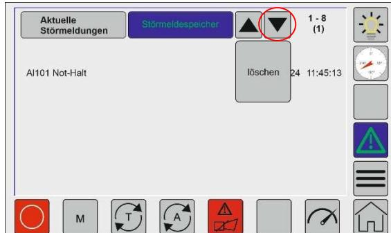
Um den Störmeldespeicher zu löschen, ist keine PIN-Eingabe nötig. Es müssen die rechte Pfeiltaste für mindestens zwei Sekunden gedrückt werden. Danach erscheint der Button „löschen“. Ein Klick auf diese Schaltfläche löscht den gesamten Störmeldespeicher.
