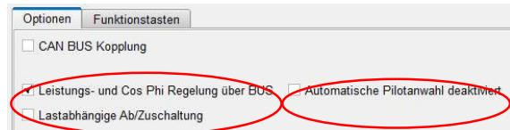
Um im Menü die Schaltfläche „BUS Einstellungen Regler“ anwählen zu können, muss diese zuerst im Parameterprogramm unter „Optionen“ aktiviert werden.
