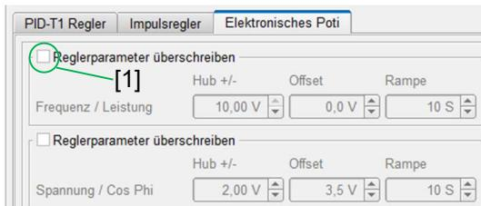
Die Verstellgeschwindigkeit am Analogausgang ist abhängig von den Einstellungen im Impulsregler und von der Rampenzzeit im Elektronischen Poti.
