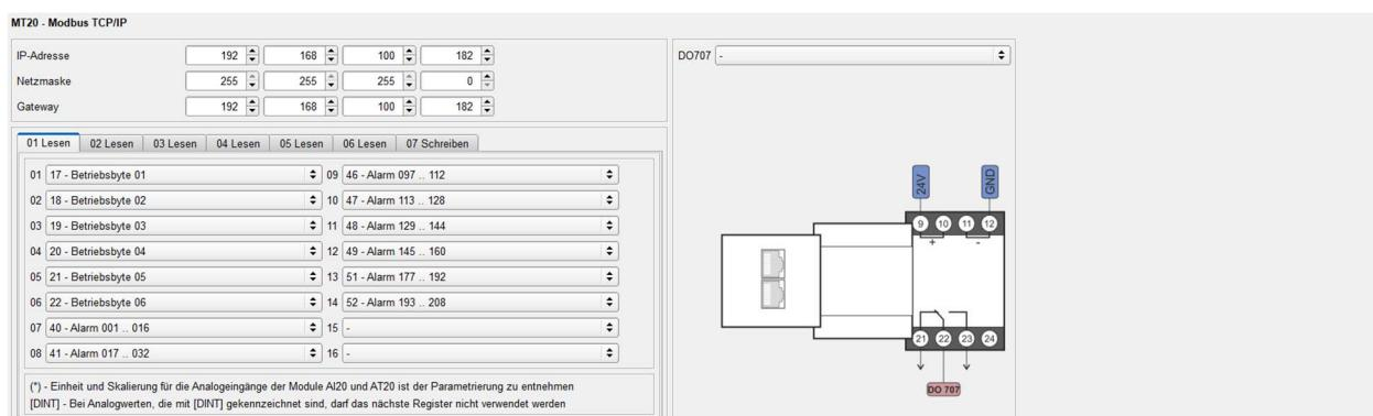
Für eine externe Datenbuskommunikation mit einer übergeordneten Steuerung steht das MT20-Modul mit einer Modbus TCP/IP-Verbindung zur Verfügung. Um die Einstellungen für die ausgewählte BUS-Kopplung vorzunehmen, muss das entsprechende Modul unter der Registerkarte „HOME“ aktiviert werden.
