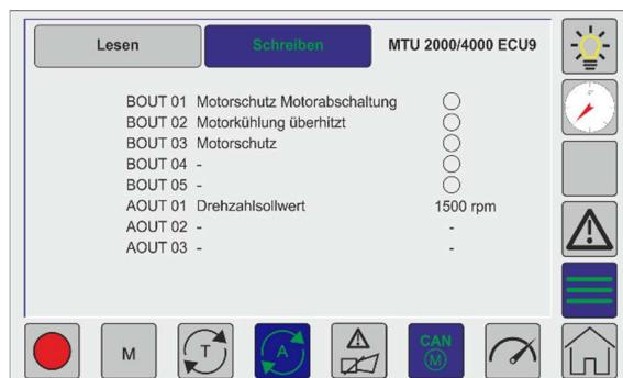
Analoge und binäre Werte, die von der GECO20 in die Motorsteuerung geschrieben werden.
