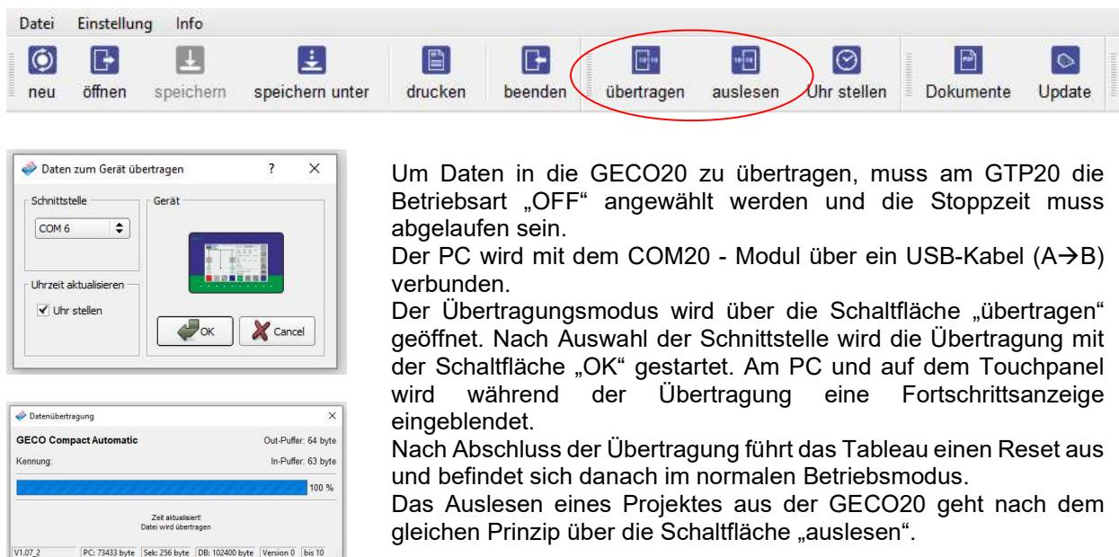
Um Daten in die GECO20 zu übertragen, muss am GTP20 die Betriebsart „OFF“ angewählt werden und die Stopzeit muss abgelaufen sein.
