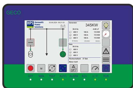
Das Anzeige- und Bediengerät GTP20 kann als Haupttableau, sowie zusätzlich als Ferntableau eingesetzt werden zur:
