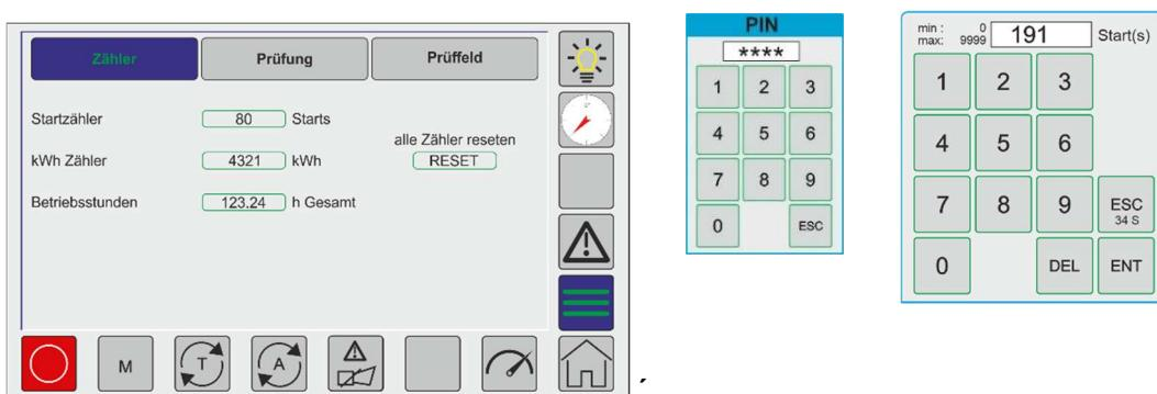
**Startzähler** - Die maximale Anzahl an Generatorstarts bis zu der gezählt werden kann, beträgt 9999 Starts.
