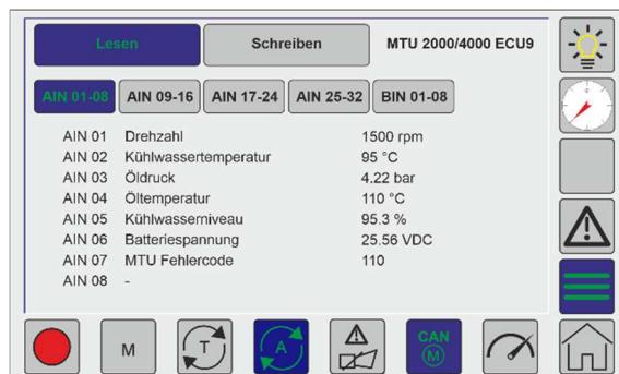
Analoge Werte, die aus der Motorsteuerung gelesen werden.
