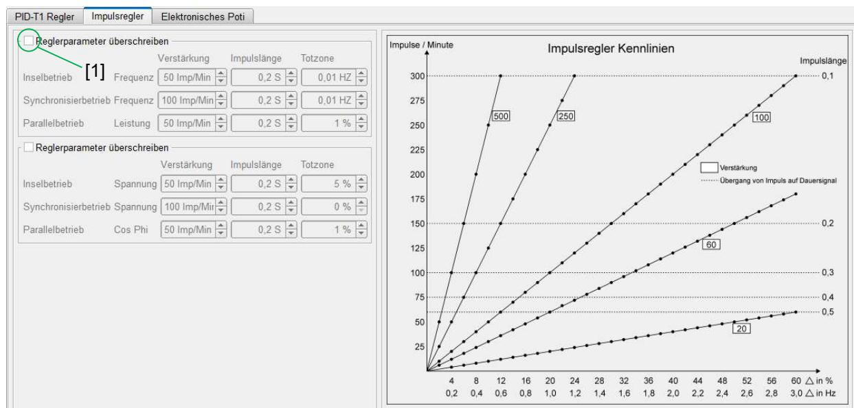
Über den Impulsregler wird das Regelverhalten der GECO20 an den jeweiligen Ausgängen beeinflusst. Für die Betriebszustände Inselbetrieb, Synchronisierbetrieb und Parallelbetrieb können unterschiedliche Parameter eingegeben werden. Die Ausgabe erfolgt entsprechend der zu regelnden Größe über die digitalen Ausgänge 'Drehzahl tiefer', 'Drehzahl höher', 'Spannung tiefer' und 'Spannung höher'.
