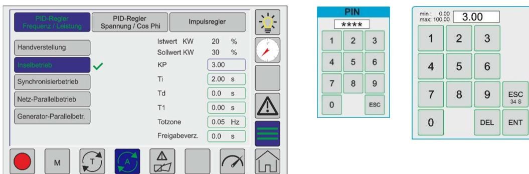
Es gibt vier verschiedene Betriebszustände für die separate Reglerparameter eingegeben werden können. Welche PID-T1-Regelparameter gerade wirksam sind, wird durch einen grünen Haken
