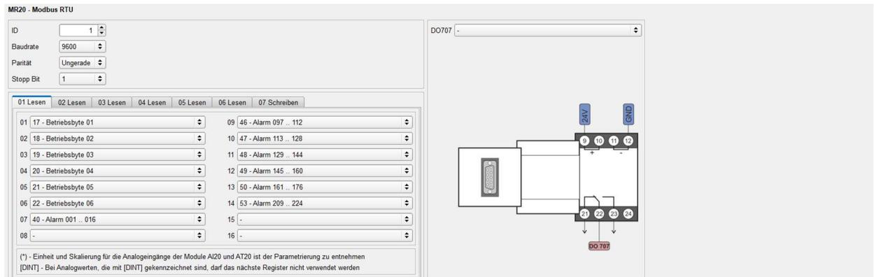
Für eine externe Datenbuskommunikation mit einer übergeordneten Steuerung steht das MR20-Modul mit einer Modbus RTU-Verbindung zur Verfügung. Um die Einstellungen für die ausgewählte BUS-Kopplung vorzunehmen, muss das entsprechende Modul unter der Registerkarte „HOME“ aktiviert werden.
