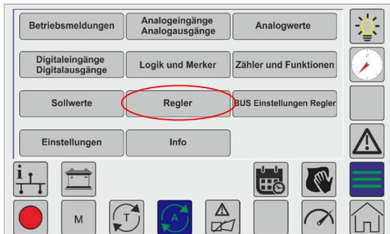
Damit die Reglermenüs angewählt werden können, müssen die entsprechenden Regler einem Analogausgang bzw. einem Digitalausgang, zugewiesen werden. Die Vorgabe für den Regelbereich der Analogausgänge ist nur über die Parametersoftware möglich.
