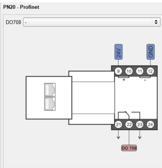
Für eine externe Datenbuskommunikation mit einer übergeordneten Steuerung steht das PN20-Modul mit einer Profinet-Verbindung zur Verfügung. Um die Einstellungen für die ausgewählte BUS-Kopplung vorzunehmen, muss das entsprechende Modul unter der Registerkarte „HOME“ aktiviert werden.
