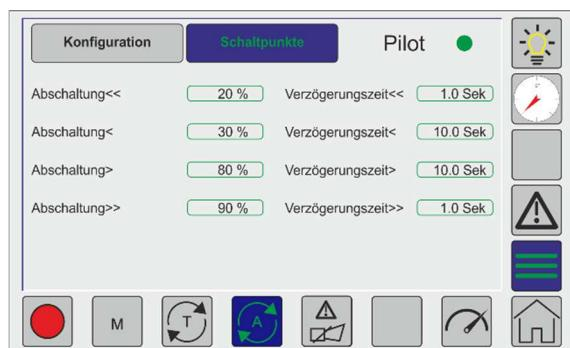
Für die Lastabhängige Ab-/Zuschaltung stehen zwei Anzeigebilder zur Verfügung. Das Bild „Konfiguration“ dient der Grundkonfiguration.
