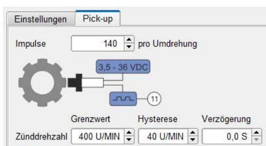
Die „Drehzahlüberwachung über Pick-up“ kann unter „HOME → Optionen“ aktiviert werden.
