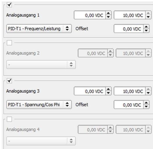
Das COM20 verfügt außerdem über vier Analogausgänge, die z.B. zur analogen Regelung von Motor- und/oder Generatorregler genutzt werden können.
