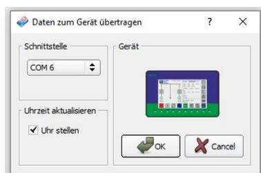
Um Daten in die GECO20 zu übertragen, muss am GTP20 die Betriebsart „OFF“ angewählt werden und die Stoppzeit muss abgelaufen sein.
