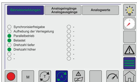
Es können bis zu 16 Betriebsmeldungen angezeigt werden. Die Farben der LEDs und der angezeigte Text ist parametrierbar (siehe Punkt 4.13).
