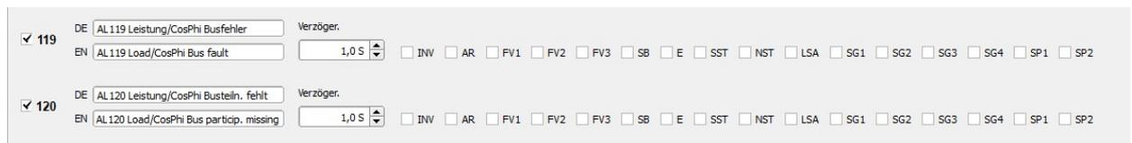
Es stehen zwei Alarme zur Verfügung, um die Buskommunikation zu überwachen. Der Alarm 119 meldet einen grundsätzlichen Busfehler und der Alarm 120 einen fehlenden Teilnehmer.
