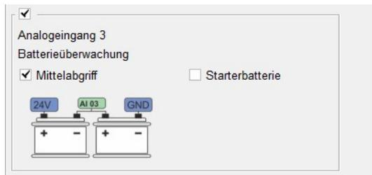
Der Analogeingang 3 kann für eine weitere Batterieüberwachung verwendet werden. Es stehen zwei Funktionen zur Verfügung.
