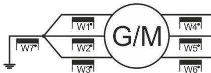
*Beispiel:* Generator-/Motorschutz mit Transformator (Erdstrommessung W7 ist optional)
