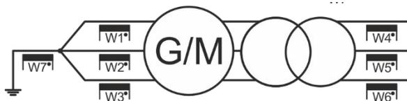
*Beispiel:* Generator-/Motorschutz mit Transformator Stern-Dreieck
