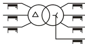
→ Der Stromwandler des Neutralleiters hat die falsche Orientierung.
