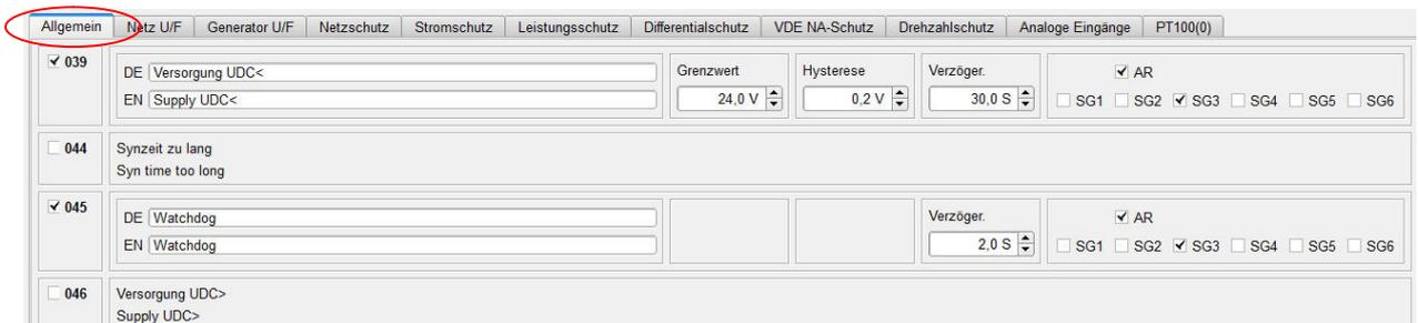
Beim Über- oder Unterschreiten des Grenzwertes kommt es nach Ablauf der Verzögerungszeit und entsprechend des Alarmverhaltens (siehe Punkt 4.5.1) zur Signalisierung des Alarms. Alle Alarme können auf einen digitalen Ausgang parametrierbar werden. Die Texte der Alarme können nicht verändert werden, weil diese Alarme mit internen Funktionsabläufen verknüpft sind.
