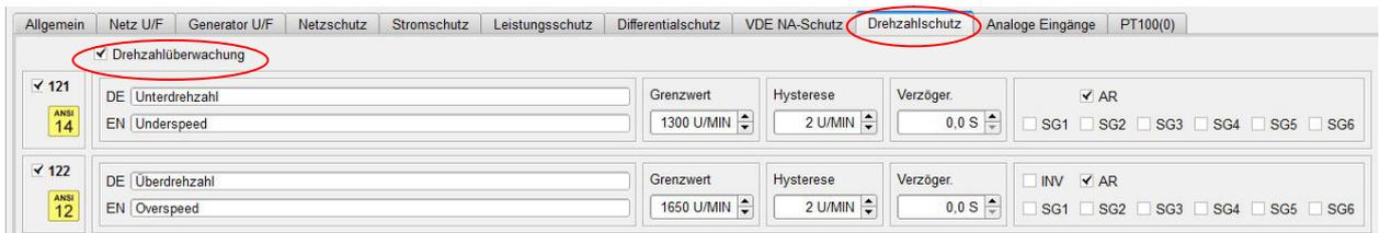
Wenn die Drehzahlüberwachung aktiviert wird können die zur Verfügung stehenden Alarme freigegeben werden.
