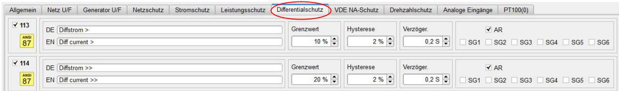
Beim Über- oder Unterschreiten des Grenzwertes kommt es nach Ablauf der Verzögerungszeit und entsprechend des Alarmverhaltens (siehe Punkt 4.5.1) zur Signalisierung des Alarms. Alle Alarme können auf einen digitalen Ausgang parametrierbar werden. Die Texte der Alarme können nicht verändert werden, weil diese Alarme mit internen Funktionsabläufen verknüpft sind.
