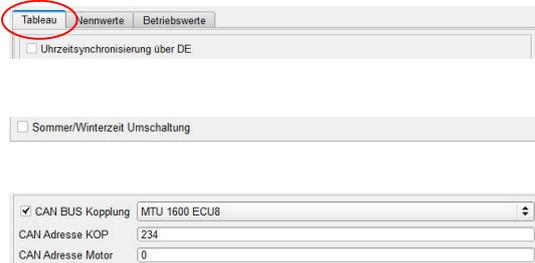
Es besteht die Möglichkeit über einen entsprechend parametrisierten digitalen Eingang, die Uhrzeit am Tableau auf den eingestellten Synzeitpunkt zu setzen.
