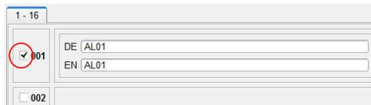
Jeder Alarm, der zur Anzeige gebracht werden soll, muss freigegeben werden. Nicht freigegebene Alarme sind grau hinterlegt.
